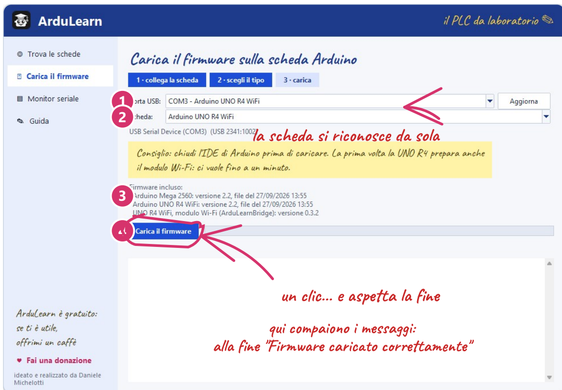
La scheda "Carica il firmware" con una UNO R4 WiFi collegata.
